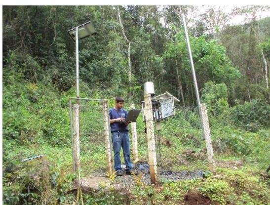
Foto 1: Coleta de dados da estação automática telemétrica Entre Rios Montante, em out/13.
