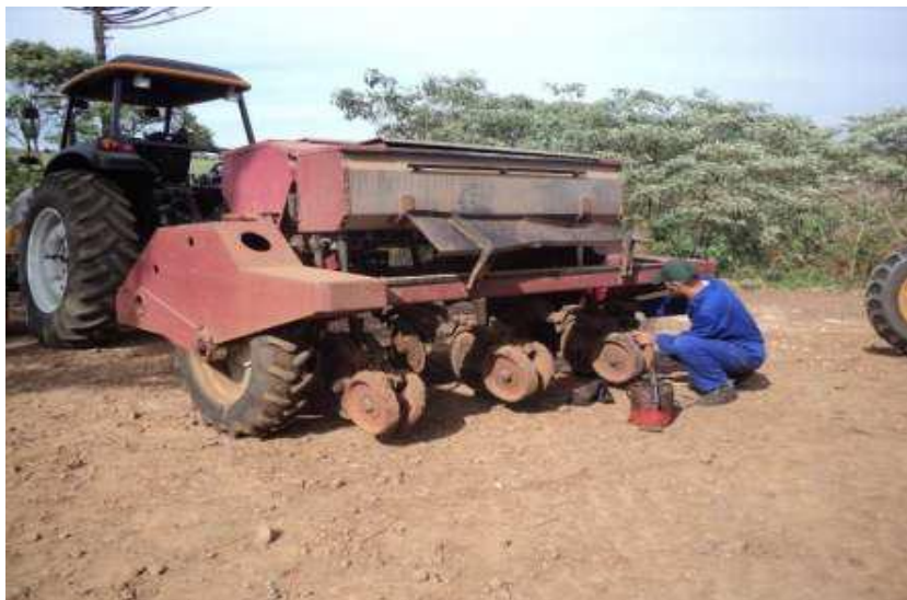
Figura 7: Lubrificação e Regulagem de Plantadeira.
