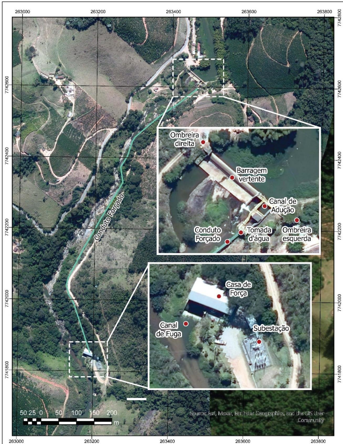
Figura 1 - Detalhamento das estruturas da PCH Viçosa
