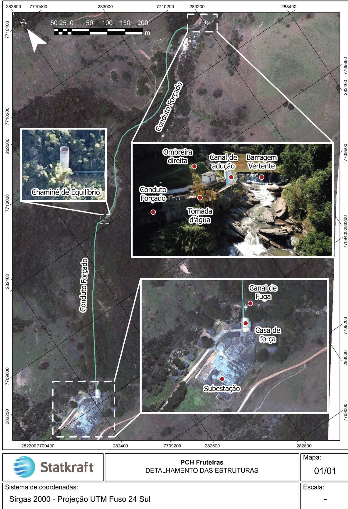
Figura 1 - Detalhamento das estruturas da PCH Fruteiras
