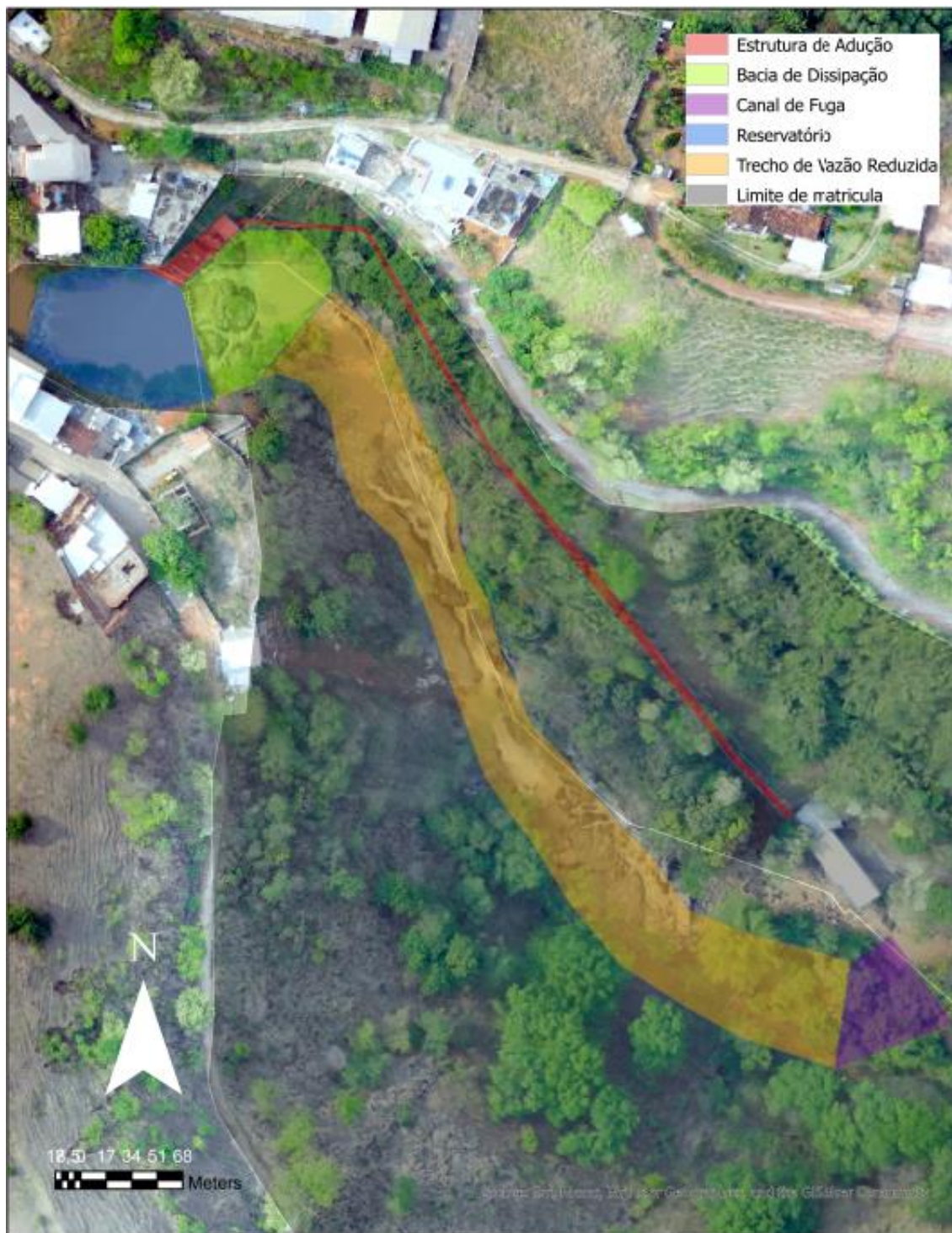
Figura 10 – Áreas de proteção junto as estruturas
