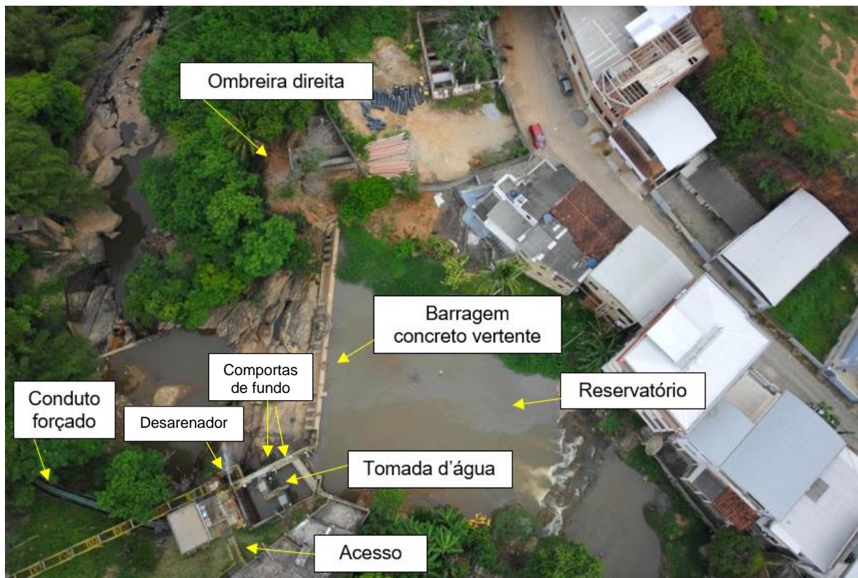
Imagem 1 – Arranjo geral da barragem
