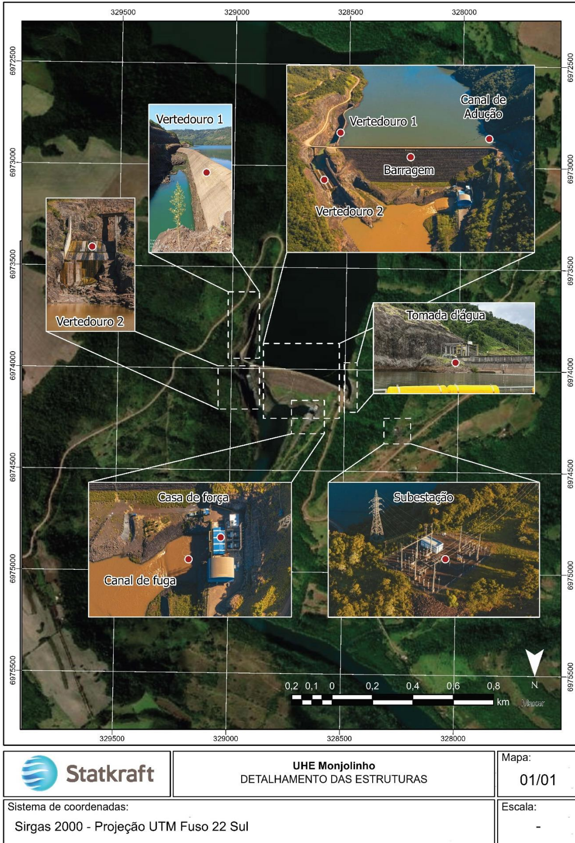
Figura 1 - Detalhamento das estruturas da UHE Monjolinho
